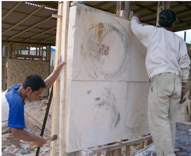
Gambar 3. Proses kerja awal adalah menentukan bahan/material serta merakit dan menjepit batu padas yang akan diukir.
