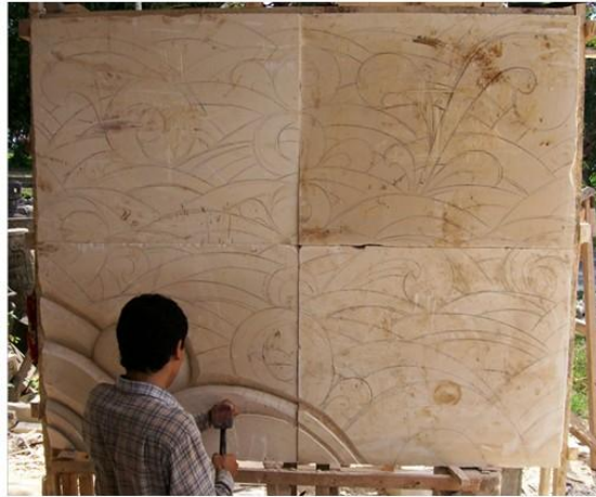
Gambar 4. Proses mengukir atau membentuk bahan batu padas
