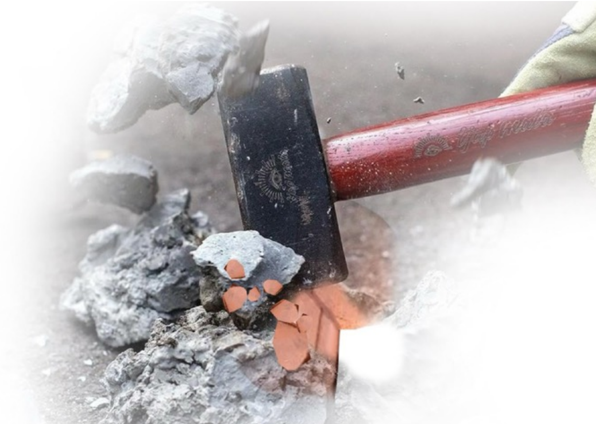
Gambar 3: Proses uji ketahanan sambungan dengan cara memukul menggunakan palu logam
