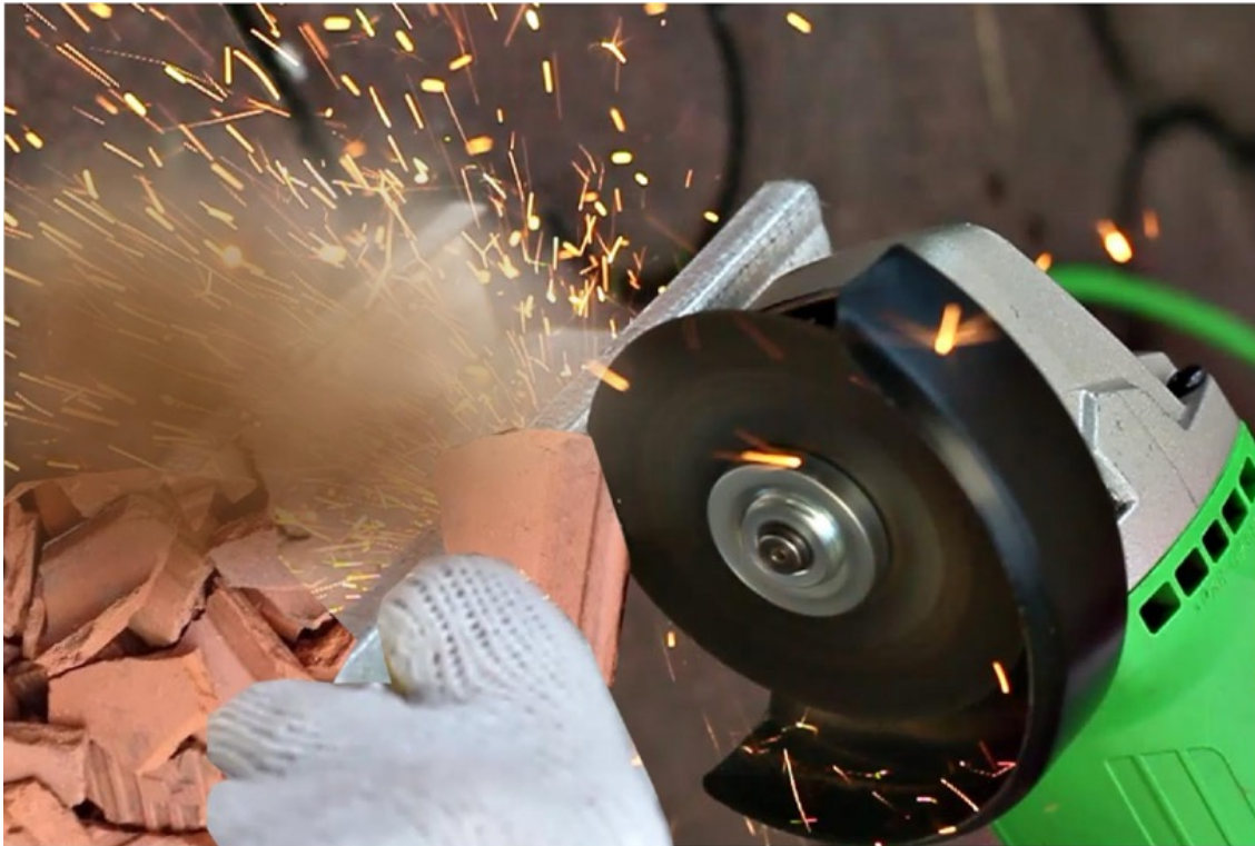
Gambar 1: Proses menggerinda pecahan genteng terakota untuk membuat sudut dan permukaan sambungan yang akan dirakit dengan lem.
