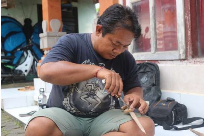
Perbaikan alat penyangga bilah yang rusak
